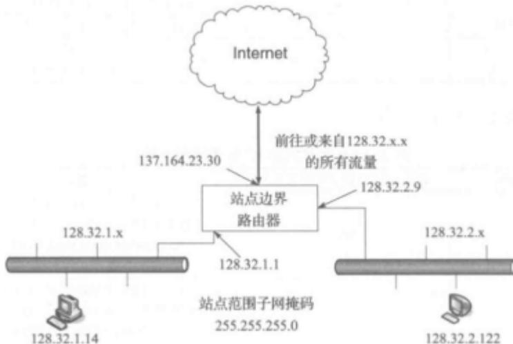
由路由器知道子网结构.左右两个以太网都是子网络,按ABCDE分类法,它们属于B类网络号,即128.32.x.x.外网的流量先经过边界路由器(这里路由器对外的IP地址为137.164.23.30),因为下面连着2个子网络,所以路由器要区分流向2个子网络的流量.它要找到子网ID.
